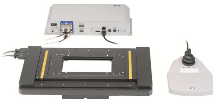
*Bild 2: Der für inverse Mikroskope mehrerer Hersteller geeignete U-780 Kreuztisch von PI basiert auf der Piezomotortechnologie. Er bietet, modellabhängig, Stellwege bis zu 135x85 mm, die Bauhöhe liegt zwischen 31mm und 48mm. © PI*
